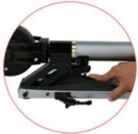
Schritt 2: Klappen Sie die Stange Schritt für Schritt in die vertikale Richtung.
