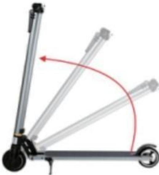
Schritt 3: Der Roller ist korrekt aufgeklappt, sobald man das Klickgeräusch hört. Es bedeutet, dass es korrekt angeschlossen ist und das Aufklappen korrekt durchgeführt wurde.
