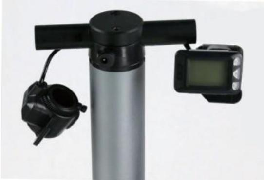
Halten Sie den Roller aufrecht, drehen Sie den Scheinwerfer nach vorne und stellen Sie sich auf die Plattenseite. Rollen Sie das Display auf der rechten Seite der Stange und rollen Sie den Bremsknopf auf der linken Seite.
