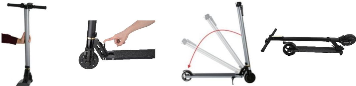
Schritt 3: Den Fahrzeuglenkhebel nach unten drücken.
